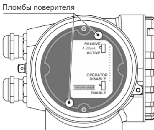
Рисунок 2.21 Пломбирование доступа к изменению метрологически значимых параметров
