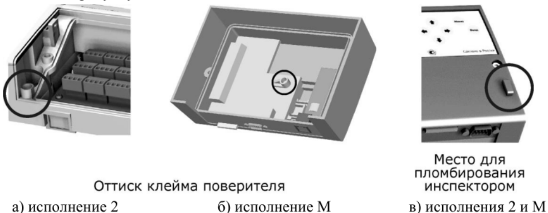
Рисунок 4 – Схема пломбировки тепловычислителя
