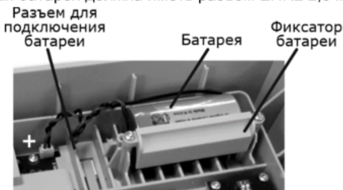
Рис.И.1 – Крепление батареи
