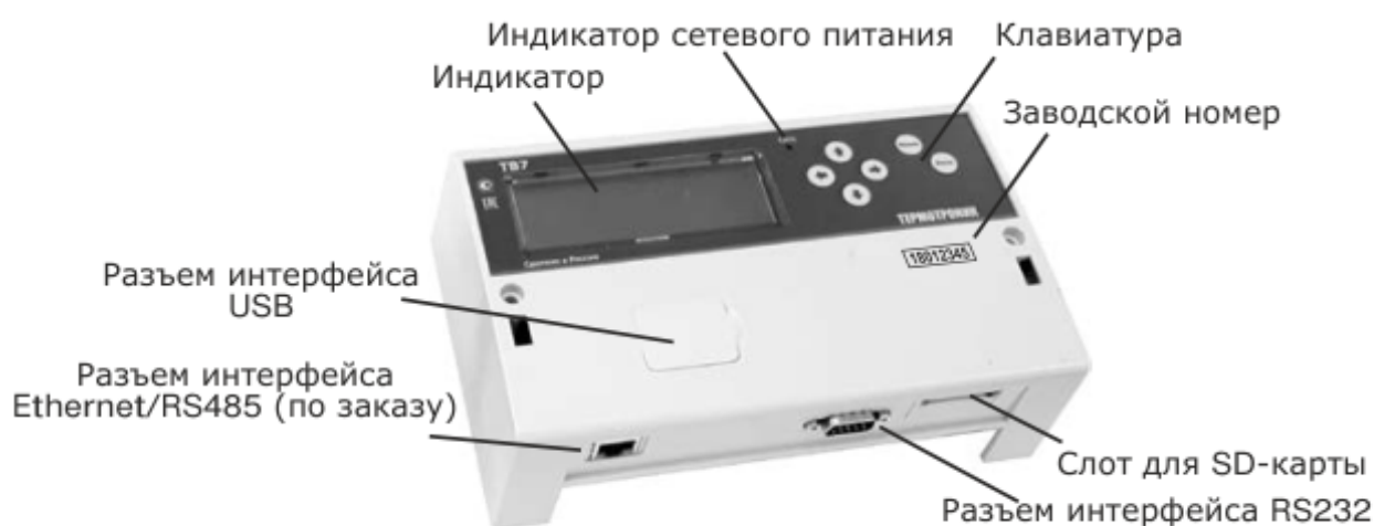
Рис. 2.1 – Внешний вид приборного отсека ТВ7 (вид сверху)
