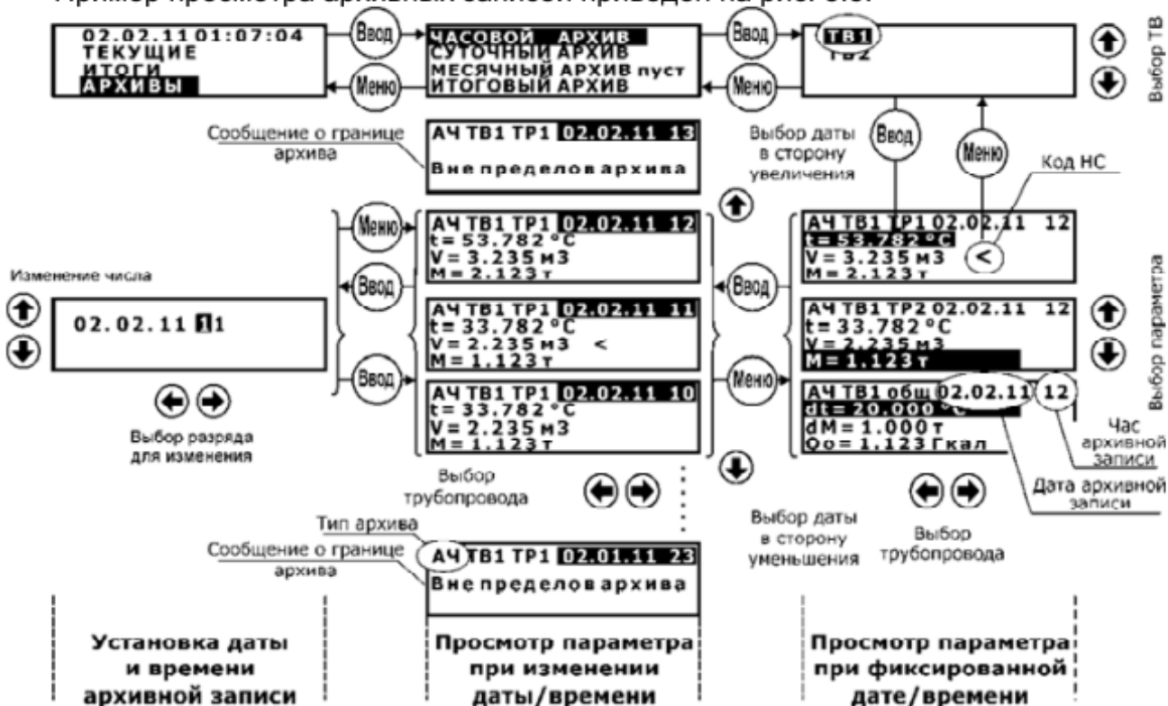
Рис. 3.5 – Примеры вывода на индикатор архивных величин
