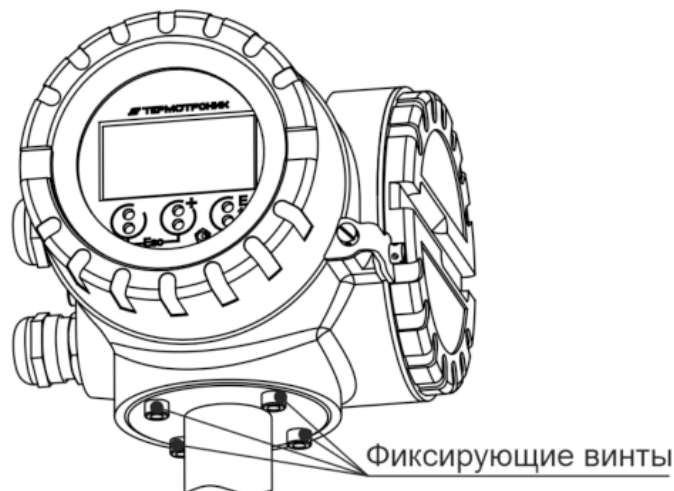
Рисунок 3.4 Поворот индикатора расходомера
