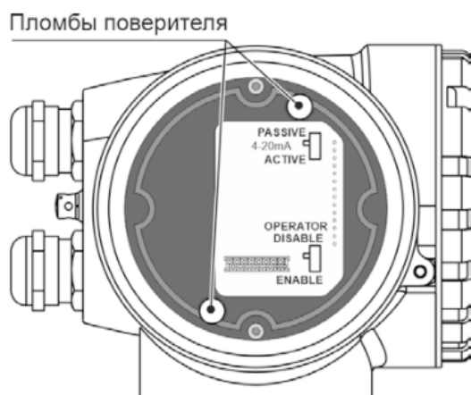
Рисунок 2.23 Пломбирование доступа к изменению метрологически значимых параметров
