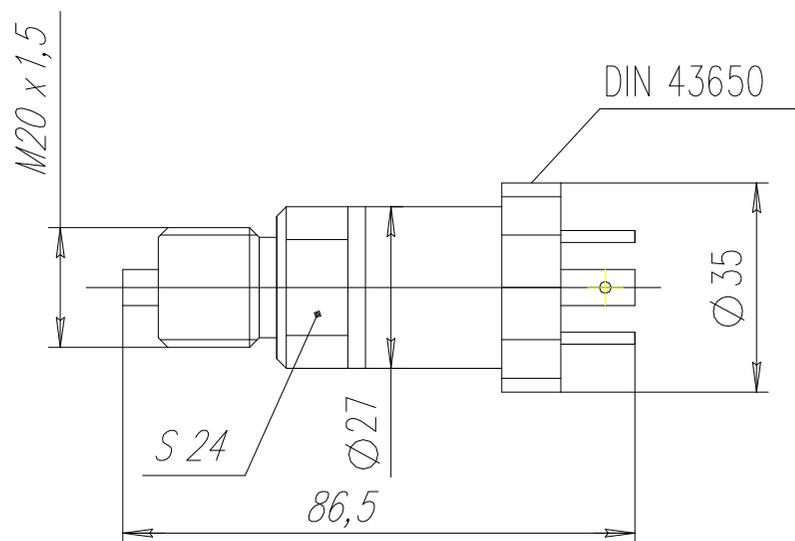
Настоящее руководство по эксплуатации распространяется на преобразователи давления измерительные с аналоговым сигналом постоянного тока СДВ-И 4-20 мА (в дальнейшем - преобразователи), содержит сведения об устройстве и принципе работы преобразователя, технические характеристики и другие сведения, необходимые для правильной эксплуатации (использования, хранения и технического обслуживания) преобразователя.
