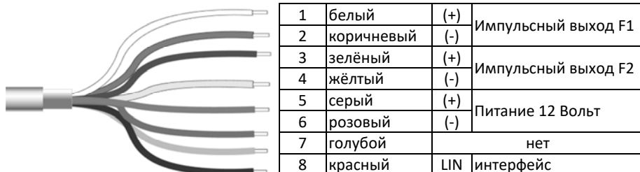
Рис. 3 Схема подключения расходомера с IP68
